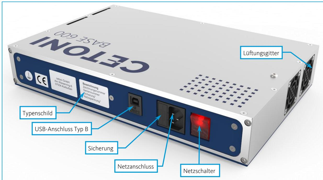
Das Basis Modul versorgt alle weiteren Module mit Strom und dient als Schnittstelle zu Ihrem PC.
