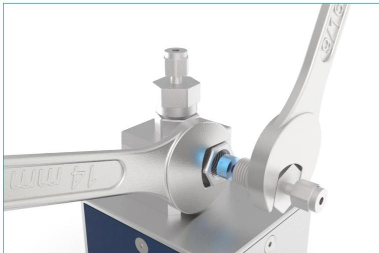
Je nach Typ der Rohrverschraubung können Kapillaren mit 1/16“ oder 1/8“ Außendurchmesser verwendet werden. Zum Anziehen und Lösen der Rohrverschraubungen benötigen Sie bei der 1/16“ Version einen 5/16“ Gabelschlüssel und bei der 1/8“ Version einen 7/16“ Gabelschlüssel.
